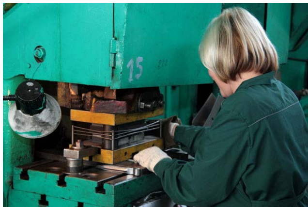
В цехах холодной высадки шум достигает 101-105 дБА
