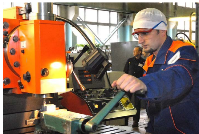
на рабочих местах токарей, фрезеровщиков, мотористов, кузнецов-штамповщиков уровень шума колеблется в пределах от 80 до 115 дБА.
