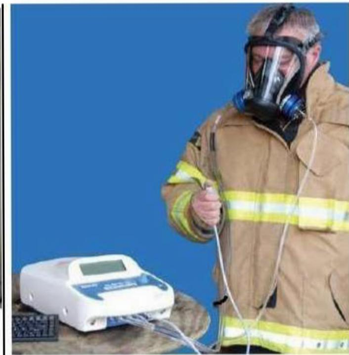
Точная проверка прибором Quantifit
